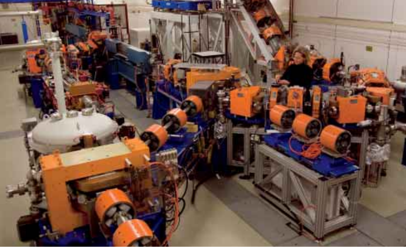
Links: De vrije-elektronen laser FELIX, met aan de rechterkant, richting plafond, de nieuwe bundellijn van FELICE.
